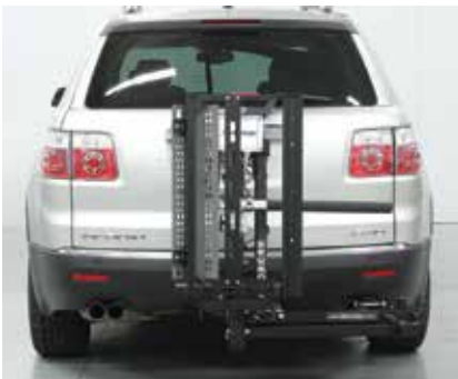
En el HTP para dispositivos con rueda en medio (MWD) caben las sillas eléctricas de ruedas eléctricas MWD con ruedas de 10 pulg. a 14 pulg. (25.4 cm a 35.6 cm).
